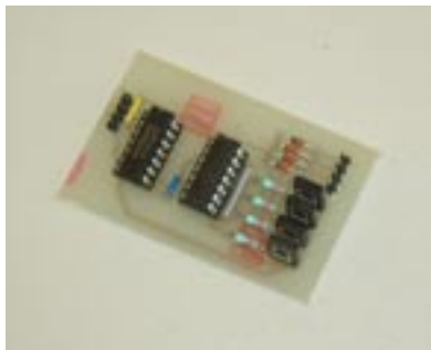
Figuur 5.3.2.3: resulterende PCB voor de aansturing van de stappenmotoren
